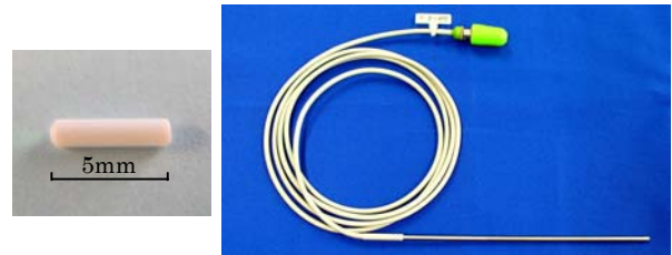
図 2 スタブ型 BOF と完成した温度センサプローブ
