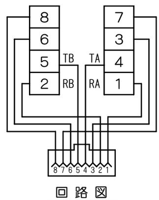
注. 端子台のL1~L8表示は、本製品と異なるため、カバー裏面の回路図を参照のこと。
