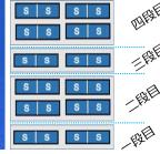
16心以上の心数のある成端箱の ご要望があり製作しました。 高さは出ます(89mm)が横幅を取らない ためコンパクトに収まります。 ◆ L C - S C変換タイプ
